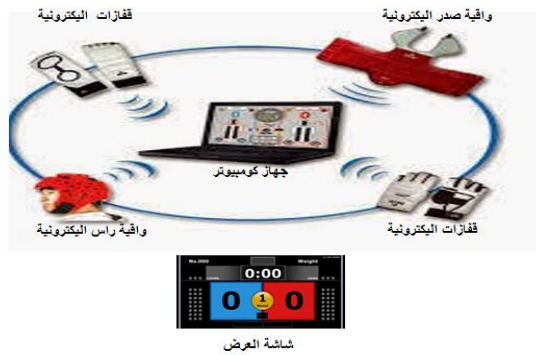
شكل (1) يوضح مكونات نظام التنقيط الإلكتروني في التايكواندو (Chan,2013,11)
