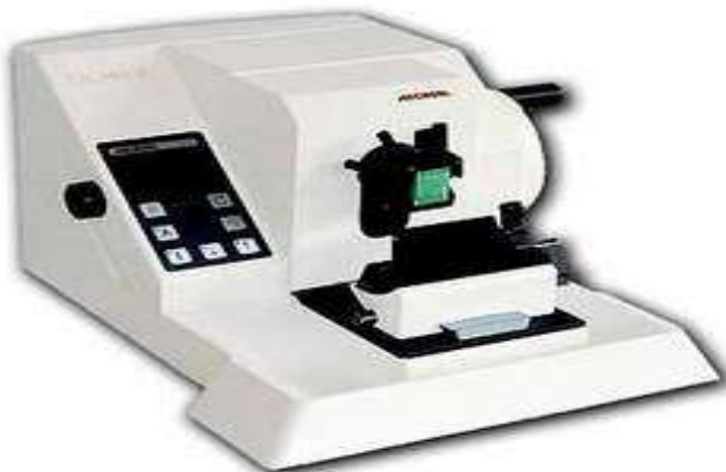
شكل ( 4-8 ) جهاز المشراح الدوار microtome
