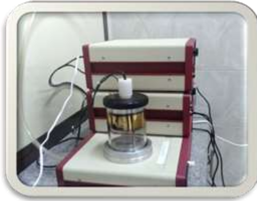
لوحة ( 7-9 ) جهاز طلاء sputtering chamber
