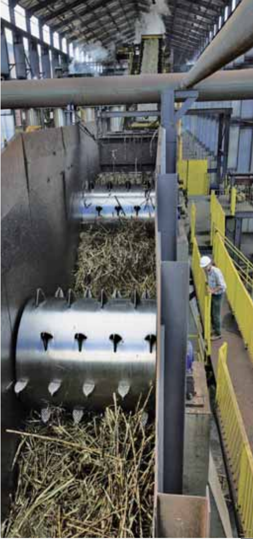
مصنع سكر في غواراني (البرازيل). داخل مصنع السكر والإيثانول هذا تقوم معاصر ضخمة بعصر قصب السكر لاستخراج عصيره. وتعد كفاءة الطاقة التي ينتجها الإيثانول المعد من قصب السكر أعلى 5 أو 6 مرات من تلك التي ينتجها إيثانول الذرة، ما يعطي ميزة حقيقية للإيثانول البرازيلي مقارنة بالإيثانول الأمريكي.
