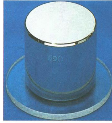
شكل (١): صورة للكيلوجرام العياري المحفوظ في وعاء مزدوج الجدران
