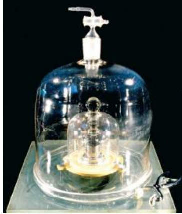
شكل (١): صورة للكيلوجرام العياري المحفوظ في وعاء مزدوج الجدران
