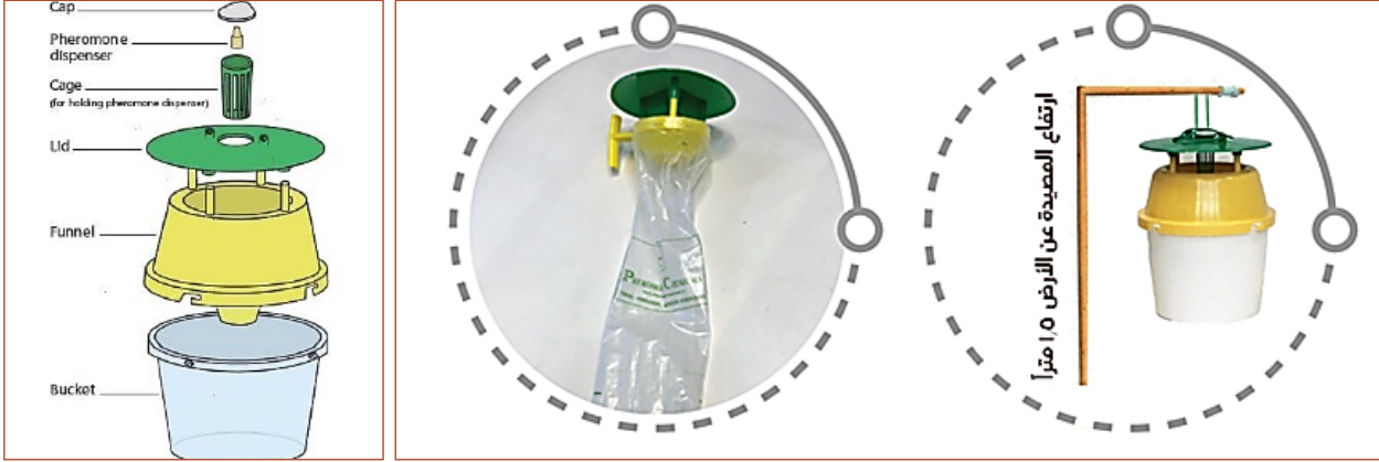
الشكل 34. أجزاء المصيدة الفرمونية وطريقة نصبها في الحقل على حامل يشبه حرف الـ L
