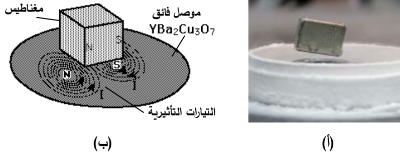
الشكل 5-7 (أ) ظاهرة الرفع فى الموصلات الفائقة، (ب) التيارات التأثيرية.
