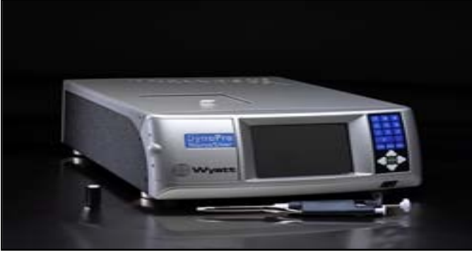
الشكل (10-15): جهاز استطارة الضوء الحركية النانوية
