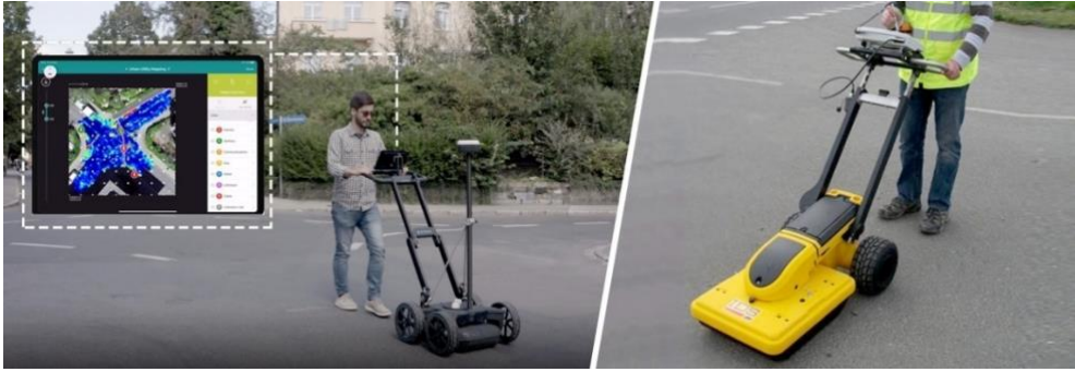
شكل (٣٢): نموذج لأجهزة رادار اختراق الأرض للبحث عن الأعطال في شبكة الصرف الصحي
