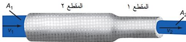
الشكل 2-17: تدفق مائع في أنبوب يتكون من جزئين بمساحات مقطع مختلفة.
