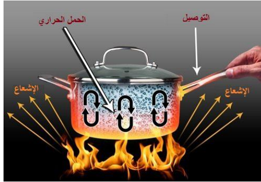
الشكل 3-1: تنتقل الحرارة من منطقة إلى أخرى بالتوصيل، أو بالحمل، أو بالإشعاع.
