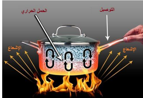
الشكل 1-3: تنتقل الحرارة من منطقة الى أخرى بالتوصيل، أو بالحمل، أو بالإشعاع.
